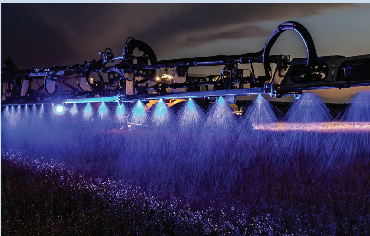
Jakość oprysku mierzona jest gęstością strumienia i stopniem pokrycia.
